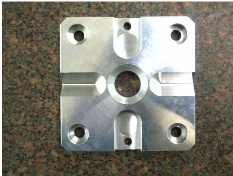
Abb.54 Vorrichtung für die Lagerung des Drahtfinders bei der Komponentenjustierung.
