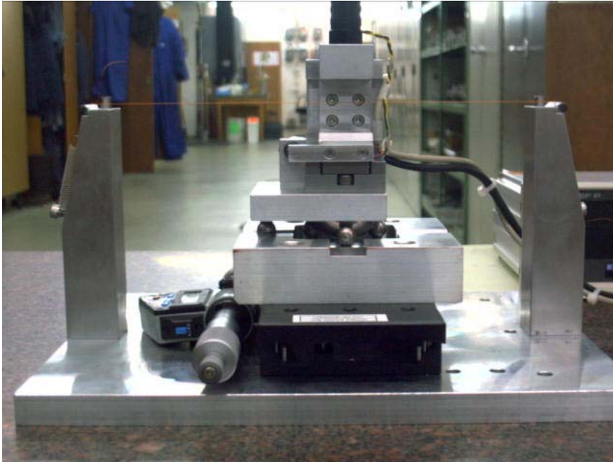
Abb.7 Zu untersuchender Drahtfinder mit Unterbau, welcher zur Kalibrierung dient.
