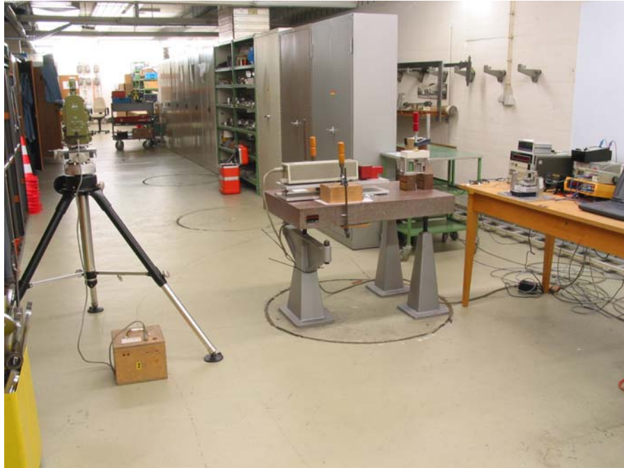
Abb. 26 Versuchsaufbau zur Ausrichtung des Messtasters.
